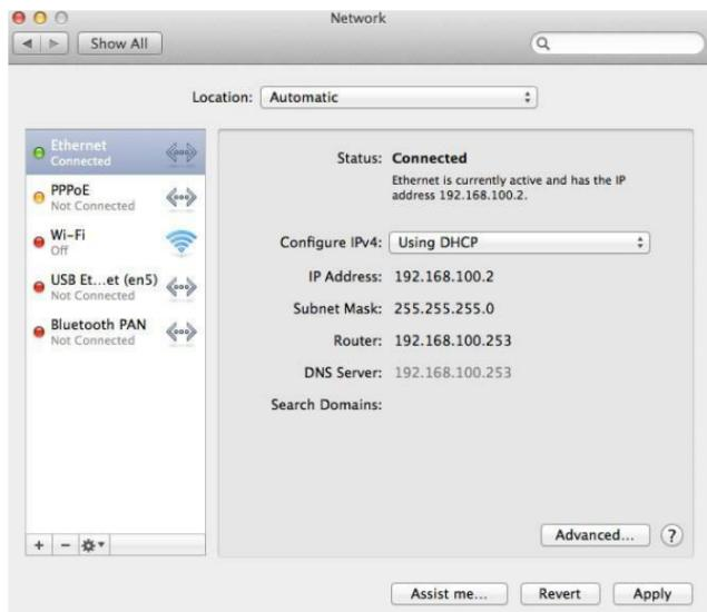
Ethernet DHCP is de standaard automatisch bekabelde verbinding. Als DHCP is ingeschakeld kunt u deze verbinding gebruiken zonder configuratie van het IP-adres. Als DHCP is uitgeschakeld moet u IP-adres handmatig configureren.
